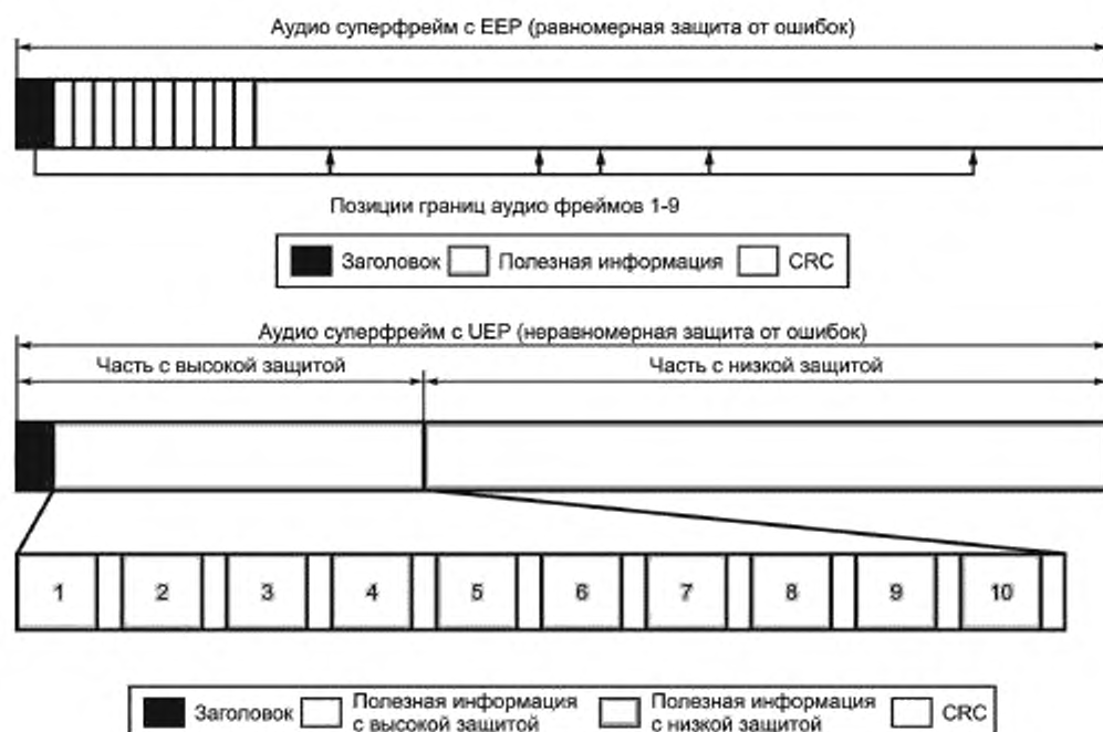
Рисунок 4 — Пример AAC аудио суперфрейма с 10 аудио фреймами
