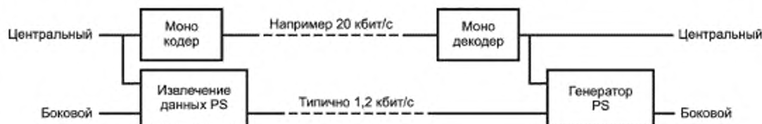
Рисунок 19 — Топология системы кодека, использующей параметрическое стерео
