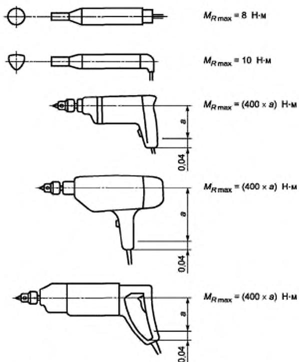
Рисунок 102 — Реактивный момент машин, удерживаемых одной рукой
