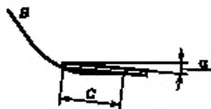
Рисунок 5 — Схема конечного участка горки
