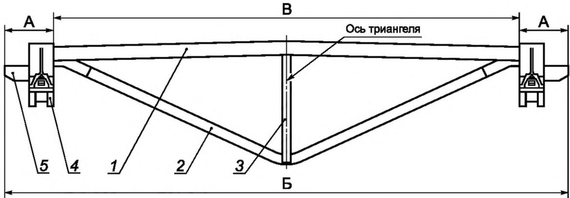
1 — балка; 2 — струна; 3 — распорка; 4 — башмак;
