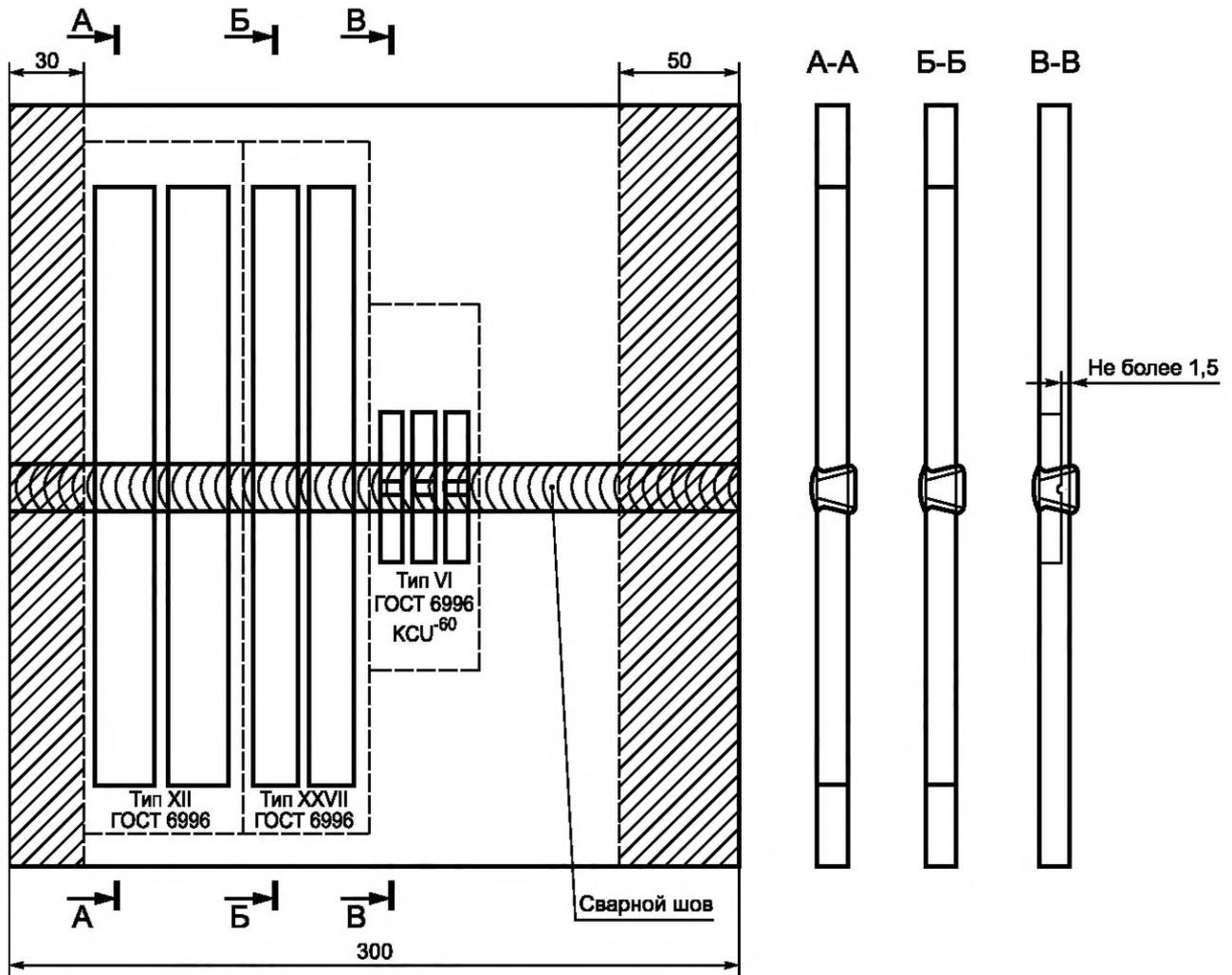
Рисунок В.3 — Схема вырезки образцов для испытаний
