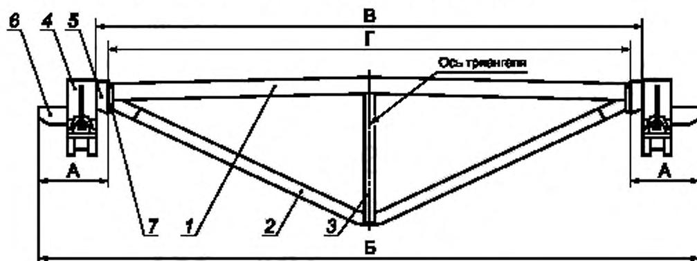
1 — балка; 2 — струна; 3 — распорка; 4 — башмак;
