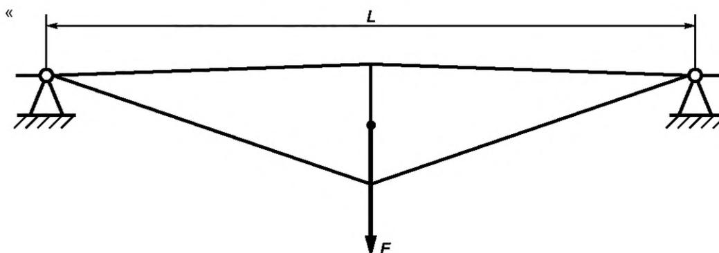
$F$  — сила (см. 5.2.2);  $L$  — расстояние между центрами опор на стенде, соответствующее расстоянию по центрам опорных поверхностей башмаков триангеля, при этом ширина каждой опоры должна быть не более ширины опорной поверхности башмака.
