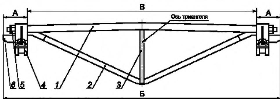
1 — балка; 2 — струна; 3 — распорка; 4 — башмак; 5 — гайка;
