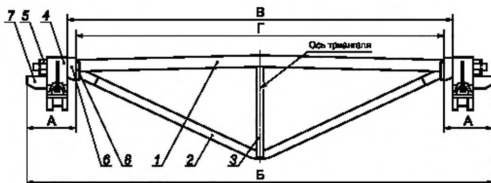
1 — балка; 2 — струна; 3 — распорка; 4 — башмак; 5 — гайка; 6 — закладка;
