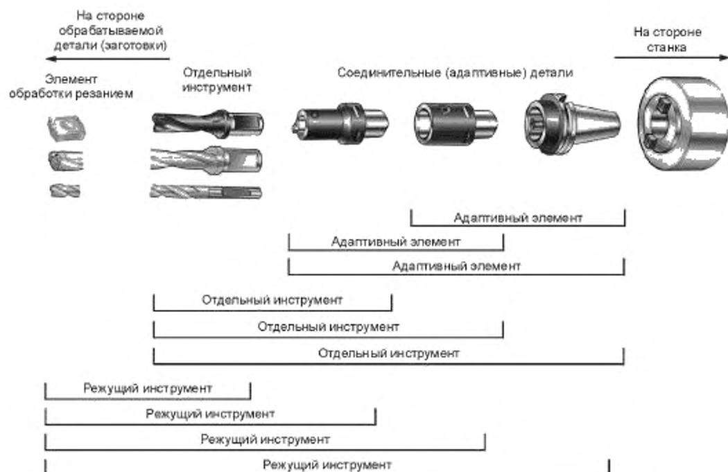
Рисунок 1 — Примеры разных типов сборок элементов
