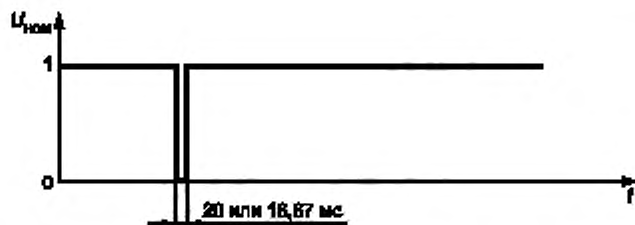
Рисунок В.2 — Прерывания напряжения \Delta U = 100\% в течение одного цикла при номинальной частоте
