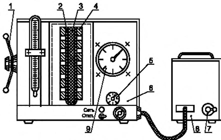
1 — рукоятка; 2 — элементарная проба; 3 — подложка; 4 — подвижная электродная система; 5 — манометр; 6 — датчик;
