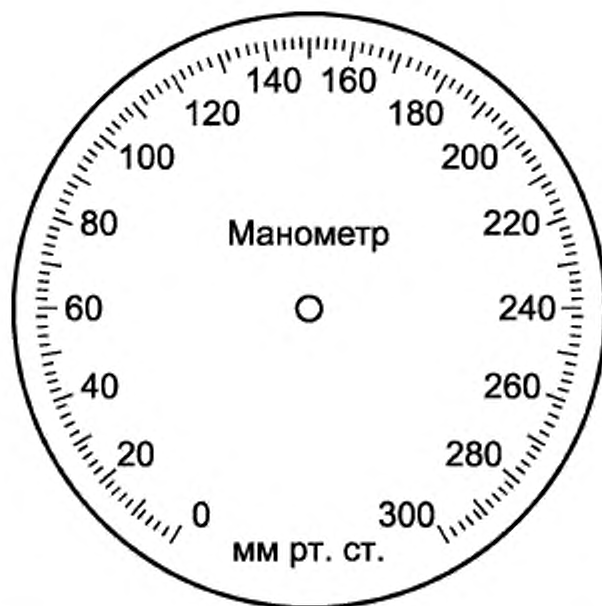
Рисунок 1 — Пример шкалы aneroidного манометра (деление, мм рт. ст., без поля допуска в положении нуля, см. 7.1.4.2.3)
