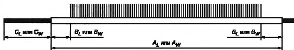
Рисунок 1 — Поперечное сечение текстильного напольного покрытия
