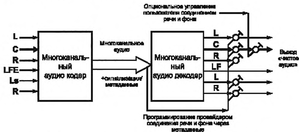
Рисунок Г.2 — Принципы обработки сигналов в декодере SA для случая «чистого аудио»
