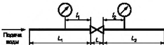
Рисунок 1 — Принципиальная схема участка расходного испытательного стэнда
