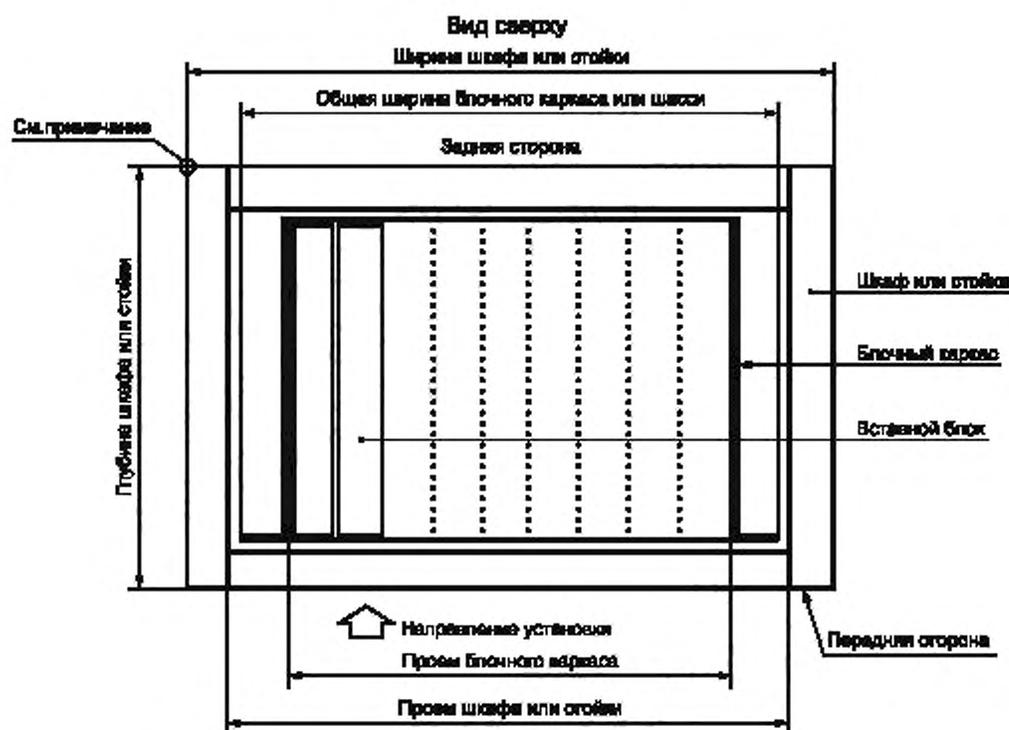
Примечание — Базовая точка  $O$  для монтажного шага 25 мм; об использовании координационной сетки указано в МЭК 60917-0 и МЭК 60917.
