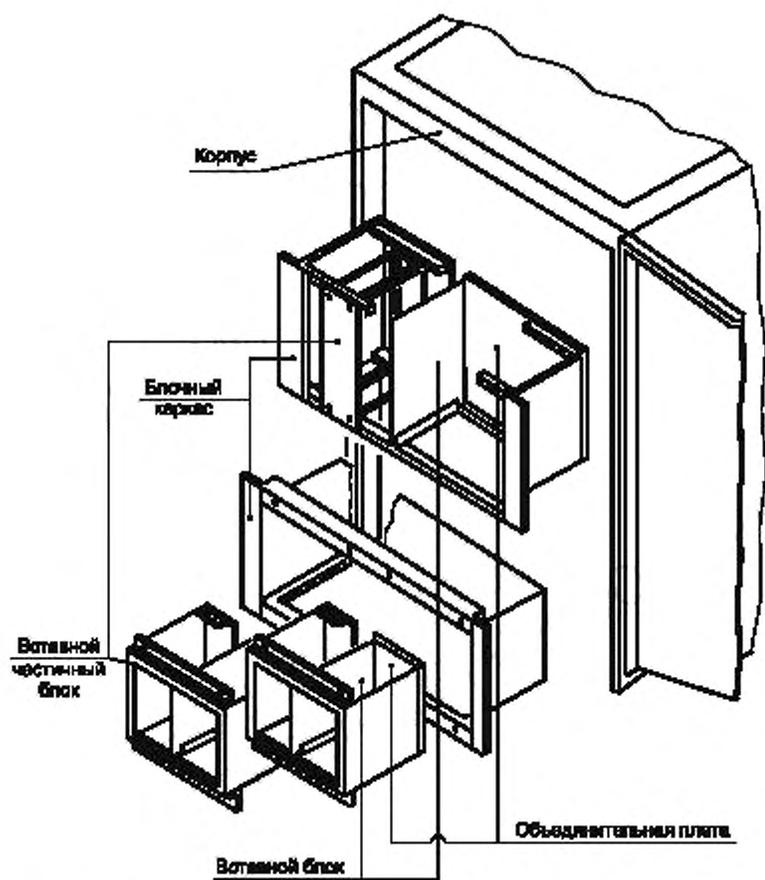
Рисунок 2 — Компоновка вставных блоков, блочных каркасов и корпусов
