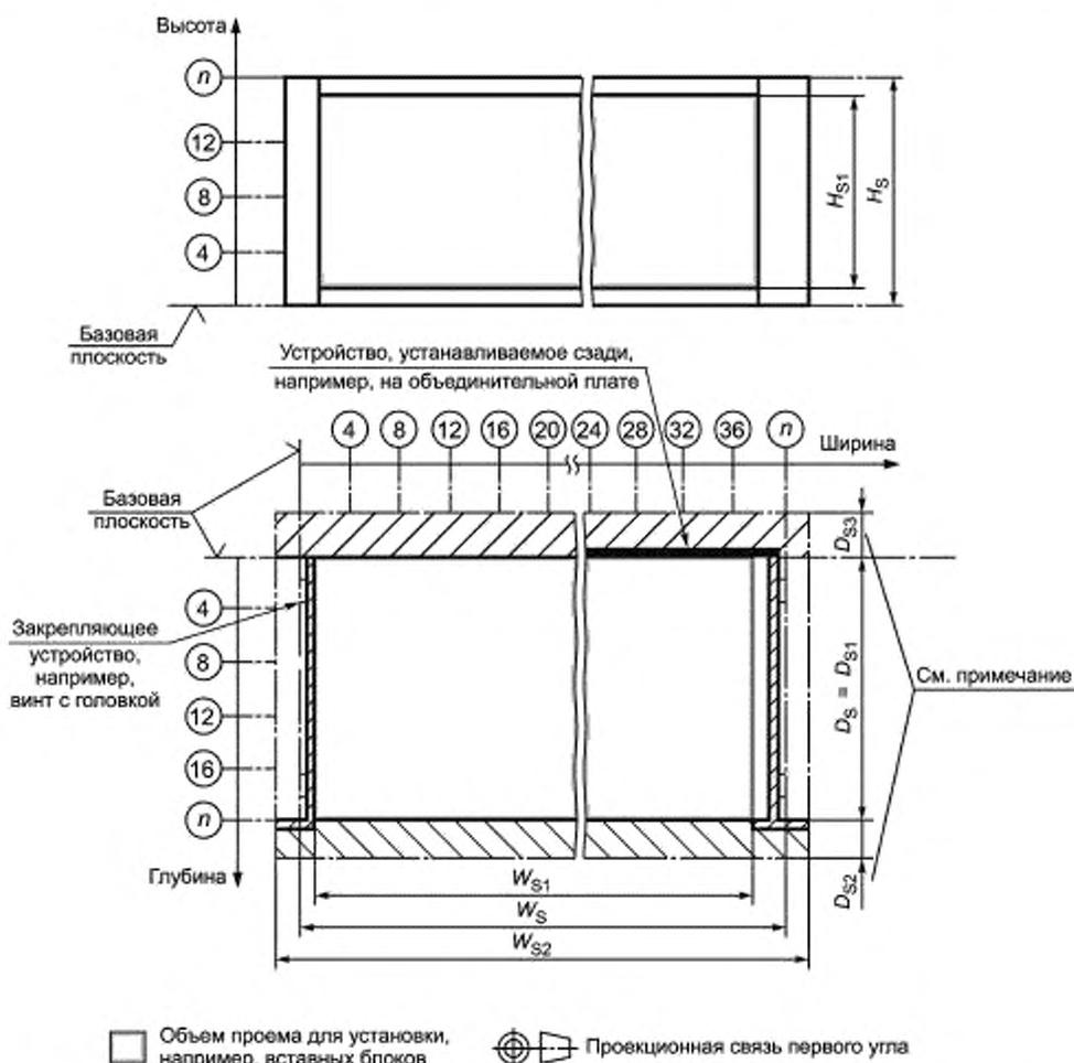
**П р и м е ч а н и е** — Дополнительный объем для проводки, охлаждения, эксплуатации, контроля и др.
