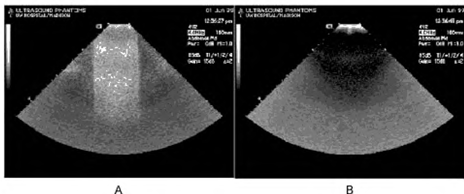
А — изображение однородной части тканемитирующего фантома; В — изображение электрических шумов после снятия датчика с фантома
