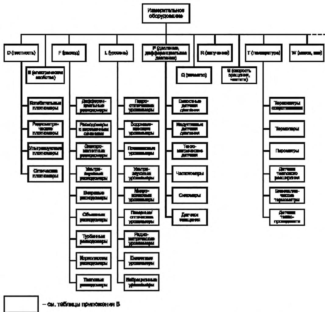
Рисунок 1 — Схема классификации производственного измерительного оборудования
