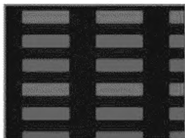
Рисунок 7 — Электролюминесцентное изображение пикселей в панели дисплея
