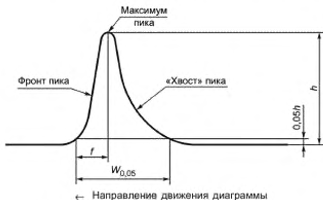
Рисунок А.2 — Асимметричный хроматографический пик
