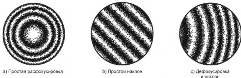
Рисунок 7 — Интерферограммы испытуемых объектов без заметных aberrаций
