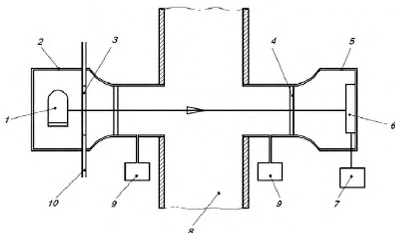
1 – источник излучения; 2 – блок излучателя; 3 – внутренняя ячейка для ввода калибровочного газа; 4 – защитное окно; 5 – блок приемника; 6 – детектор и электронный модуль; 7 – блок регистрации данных; 8 – газопровод или труба; 9 – нагнетатель продувочного воздуха; 10 – трубка для подачи калибровочного газа
