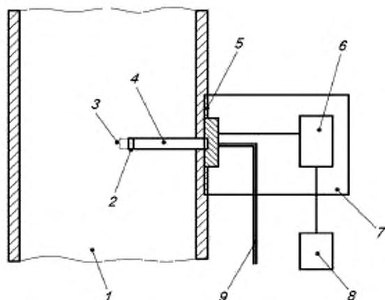
1 – газопровод или труба; 2 – измерительная ячейка; 3 – фильтр для защиты измерительной ячейки; 4 – зонд; 5 – крепление зонда; 6 – приемопередающий блок; 7 – защитный кожух; 8 – блок регистрации данных; 9 – трубка для подачи калибровочного газа
