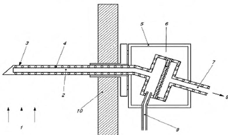
1 – поток отходящего газа; 2 – зонд; 3 – защитная трубка; 4 – нагреватель;
