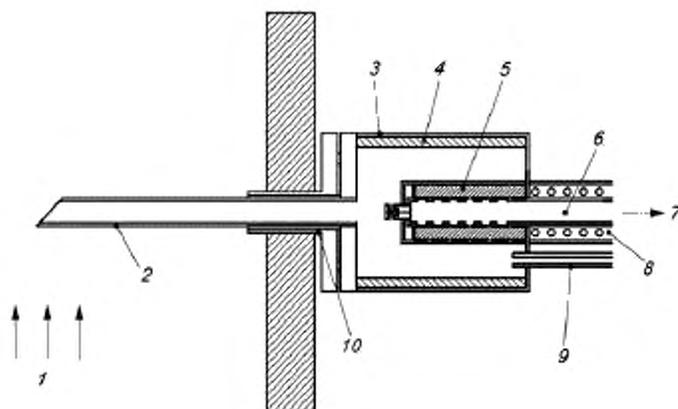
1 – поток отходящего газа; 2 – зонд; 3 – водонепроницаемый кожух; 4 – нагреватель;
