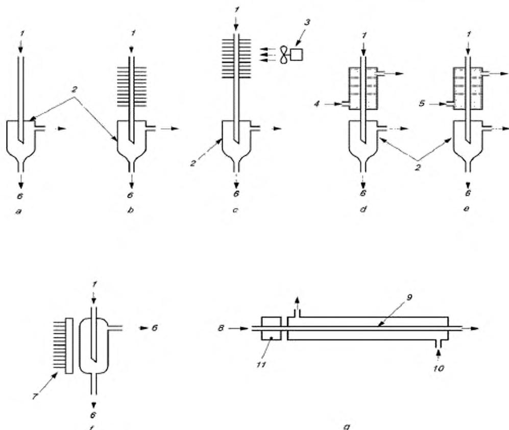
а – охлаждение до комнатной температуры; б – охлаждение до комнатной температуры; с – принудительное охлаждение воздухом; д – охлаждение водяной рубашкой; е – охлаждение хладагентом; ф – термоэлектрическое охлаждение; г – осушитель (полупроницаемый материал, тефлон или эквивалентные материалы)
