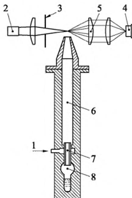
1 – вход аэрозоля, 2 – лазерный диод, 3 – отверстие, 4 – фотоприемник, 5 – световая ловушка,
