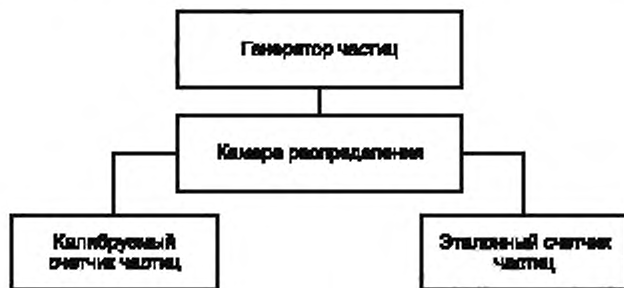
Рисунок В.1 — Пример системы контроля эффективности счетчика
