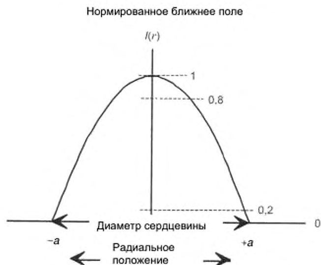
Рисунок С.2 – Диаметр поперечного сечения сердцевины. Сканирование интенсивности ближнего поля, способ 2
