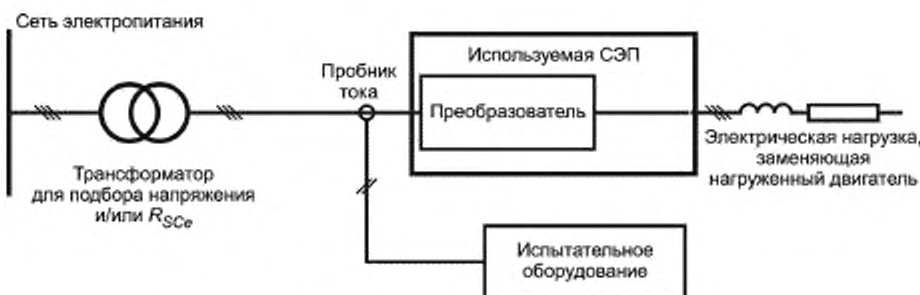
Рисунок В.7 — Испытательная установка с электрической нагрузкой, заменяющей нагруженный двигатель
