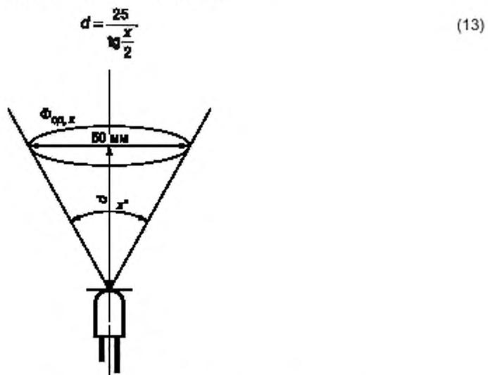
Рисунок 4 — Пояснения к определению частичного светового потока светодиодов
