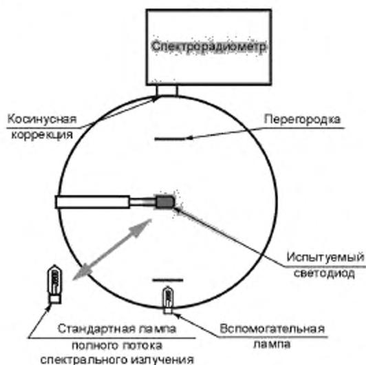
Рисунок 6 — Оптическая схема измерений в режиме полного потока
