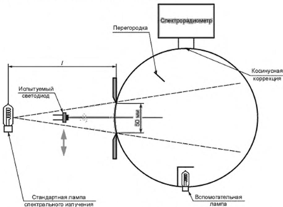
Рисунок 7 — Оптическая схема измерений в режиме частичного светового потока
