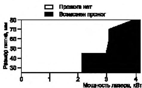
Рисунок F.18 — Стойкость к разрушению листа оцинкованной стали толщиной 3 мм от 100 с экспозиции расфокусированного пучка во время экспериментов с использованием непрерывного лазера на иттрий-алюминиевой гранате с неодимом
