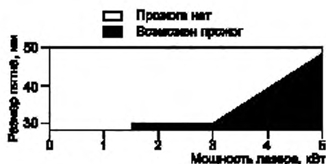
Рисунок F.1 — Стойкость к разрушению листа оцинкованной стали толщиной 1 мм от 10 с экспозиции расфокусированного пучка во время экспериментов с использованием непрерывного лазера на углекислом газе
