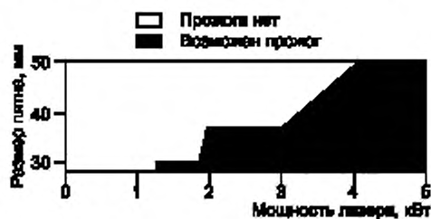
Рисунок F.2 — Стойкость к разрушению листа оцинкованной стали толщиной 1 мм от 100 с экспозиции расфокусированного пучка во время экспериментов с использованием непрерывного лазера на углекислом газе
