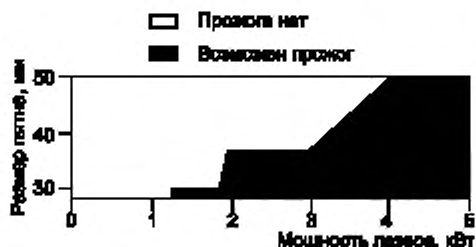
Рисунок F.9 — Стойкость к разрушению листа нержавеющей стали толщиной 1 мм от 10 с экспозиции расфокусированного пучка во время экспериментов с использованием непрерывного лазера на углекислом газе
