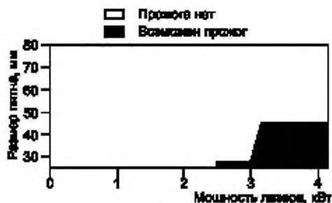
Рисунок F.19 — Стойкость к разрушению листа алюминия толщиной 2 мм от 10 с экспозиции расфокусированного пучка во время экспериментов с использованием непрерывного лазера на иттрий-алюминиевой гранате с неодимом
