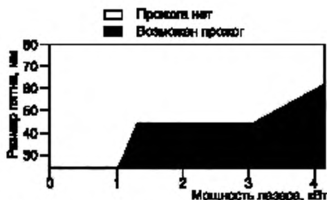
Рисунок F.20 — Стойкость к разрушению листа алюминия толщиной 2 мм от 100 с экспозиции расфокусированного пучка во время экспериментов с использованием непрерывного лазера на иттрий-алюминиевой гранате с неодимом
