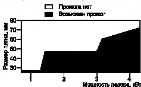
Рисунок F.22 — Стойкость к разрушению листа нержавеющей стали толщиной 1 мм от 100 с экспозиции расфокусированного пучка во время экспериментов с использованием непрерывного лазера на иттрий-алюминиевой гранате с неодимом
