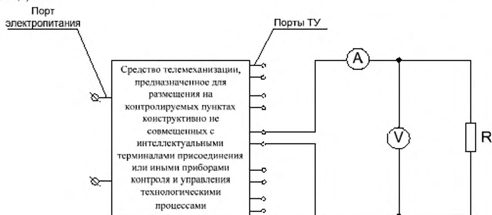
Рисунок 2 – Схема проверки параметров сигнала ТУ
