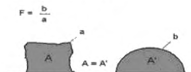
A — тень области образца (фактическое изображение); A' — площадь образца после компьютерной оценки изображения (эквивалент теневой площади); a — реально измеряемый контур, b — идеальный контур
