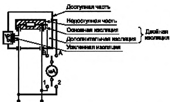
Рисунок 4 – Схема измерения тока утечки при рабочей температуре для однофазных приборов класса II
