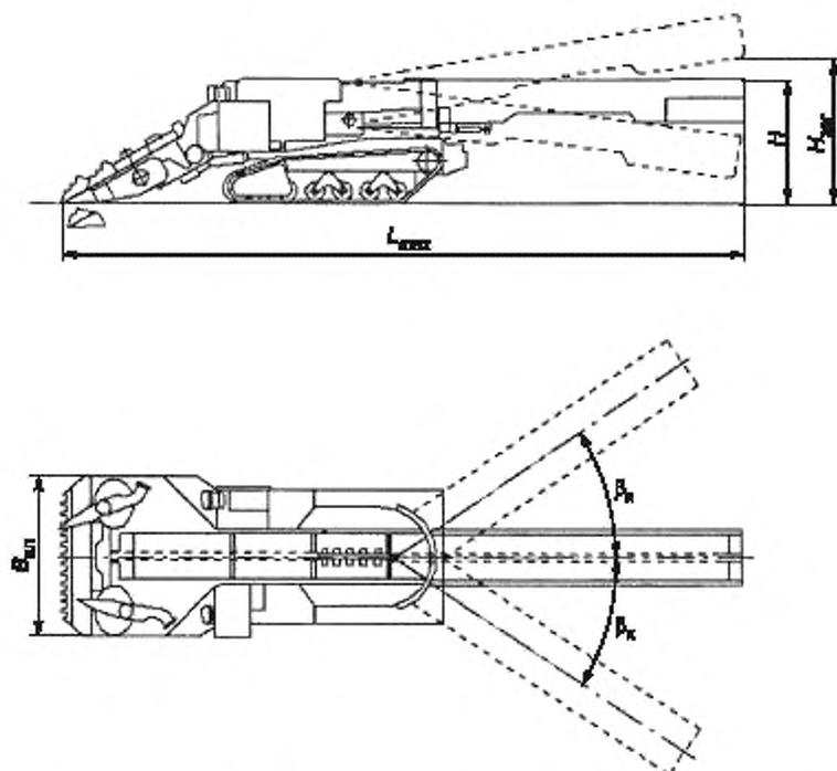
$H$  — транспортная высота;  $H_{\text{заг}}$  — высота загрузки;  $L_{\text{max}}$  — максимальная длина машины;
