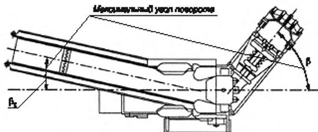
Рисунок 8 — Проверка машины на поперечную устойчивость
