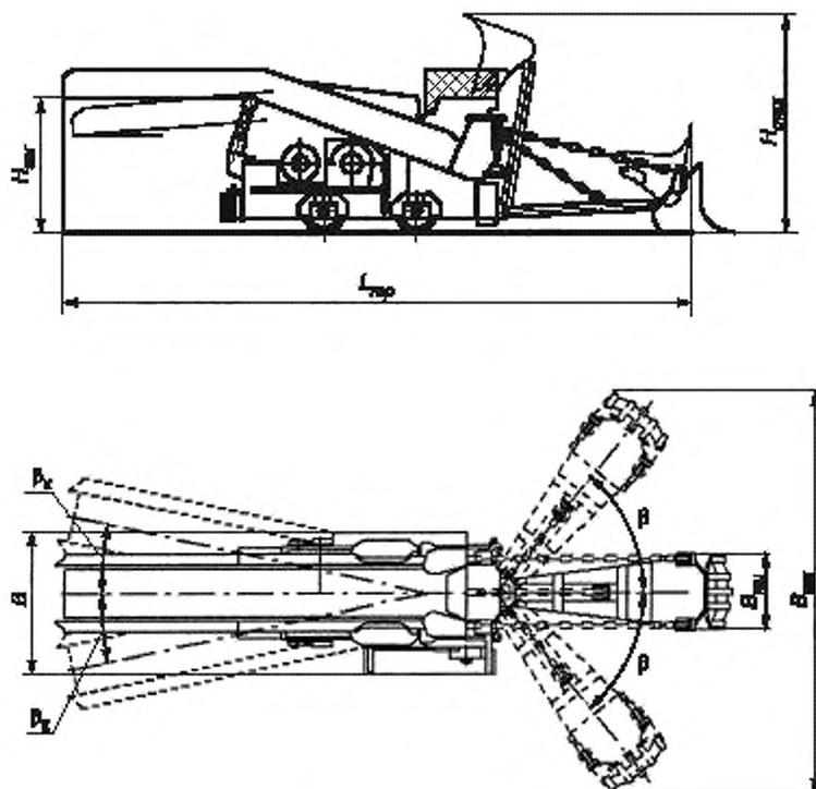
$H_{max}$  — максимальная высота;  $H_{заг}$  — высота загрузки;  $L_{тп}$  — транспортная длина машины;  $B$  — ширина машины;
