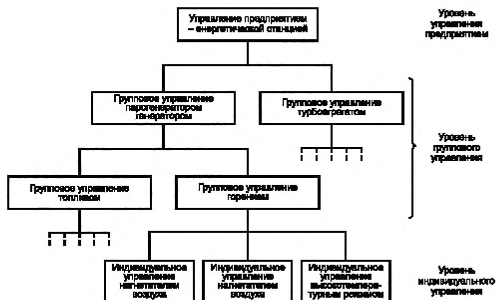
Рисунок А.6 — Уровни управления энергетической станцией (ТЭЦ)
