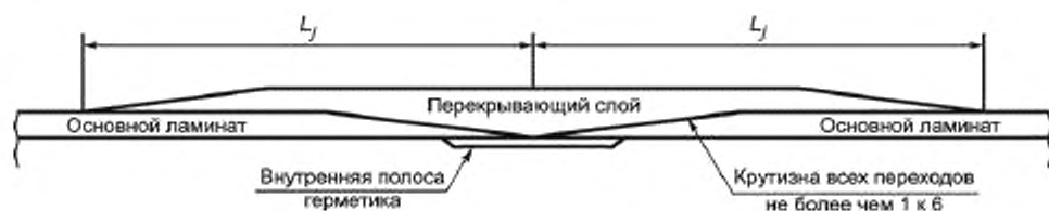
Рисунок И.3 — Основные типы сварных соединений для напорных емкостей без термопластичной футеровки: клинообразный стык-соединение
