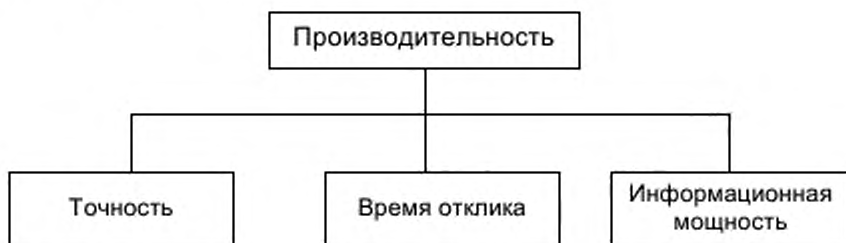
Рисунок 2 — Иерархия свойств производительности системы
