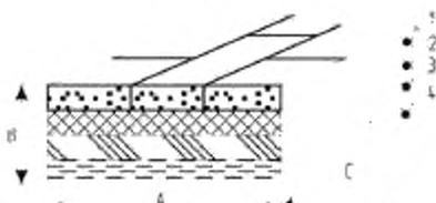
*A* – длина; *B* – толщина; *C* – ширина; 1 – специализированный слой из штучного футеровочного материала; 2 – химостойкий слой; 3 – механически прочный слой; 4 – эластичный слой
