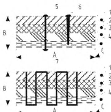
*A* – длина; *B* – толщина; *C* – ширина; 1 – листовый специализированный термостойкий слой; 2 – химостойкий слой; 3 – механически прочный слой; 4 – эластичный слой; 5 – заклепка; 6 – саморез; 7 – нить
