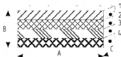
*A* – длина; *B* – толщина; *C* – ширина; 1 – специализированный химостойкий слой; 2 – химостойкий слой; 3 – механически прочный слой; 4 – клеевой слой на основе клея, праймера, мастики, клеящей шпатлевки
