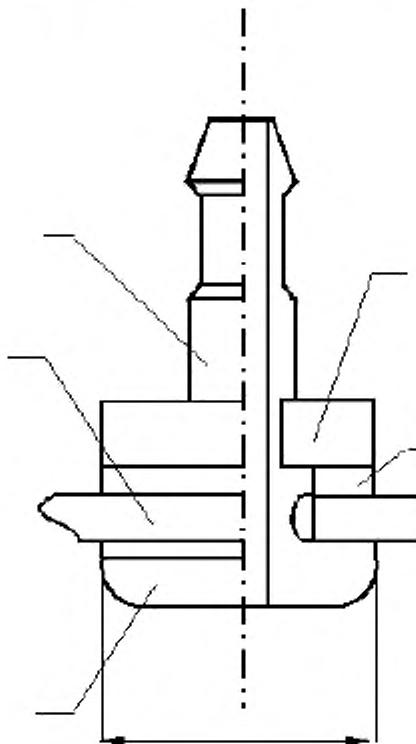
1 — фланец; 2 — дыхательный мешок или трубка линии вдоха; 3 — корпус; 4 — гайка; 5 — шайба
