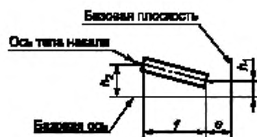
Рисунок 3 — Допустимое смещение оси тела накала 12)
