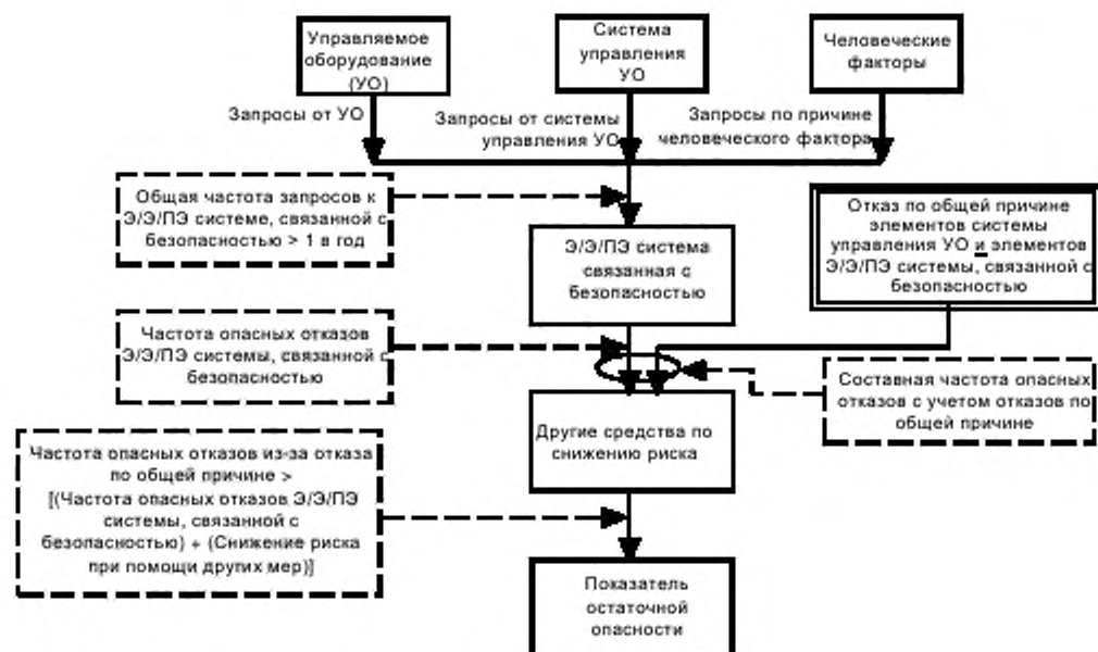
Рисунок А.5 – Иллюстрация отказов по общей причине элементов в системе управления УО и элементов Э/Э/ПЭ системы, связанной с безопасностью
