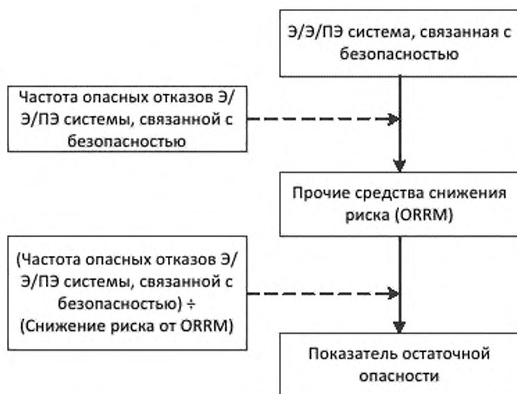
Рисунок А.4 – Диаграмма риска для применений, работающих в непрерывном режиме запросов на обслуживание
