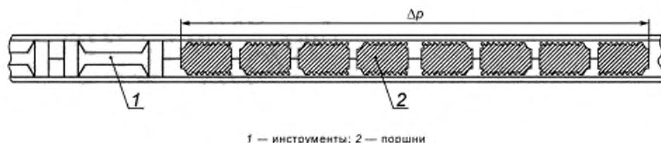
Рисунок 1 — Дифференциальное давление \Delta p
