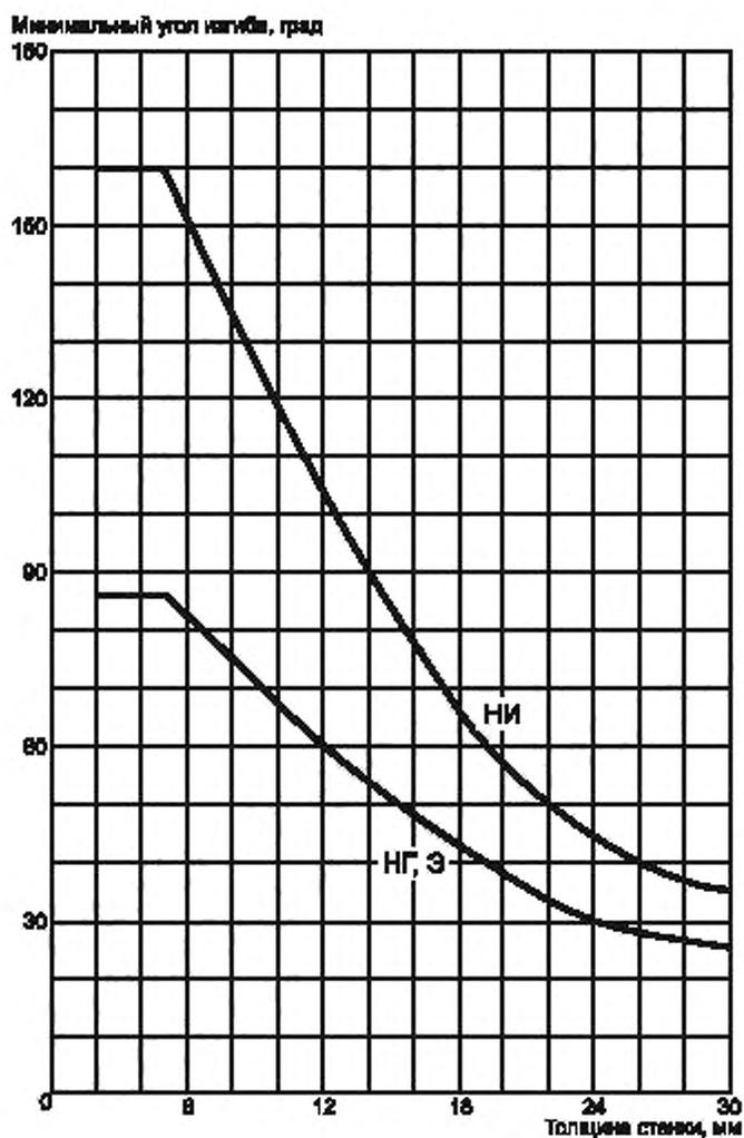
Рисунок В.3 — Минимальный угол изгиба для ПП-Р (тип 3) в зависимости от толщины для разных методов сварки (верхняя кривая — для сварки нагретым инструментом встык, нижняя — для прутковой газовой сварки и экструзионной сварки)
