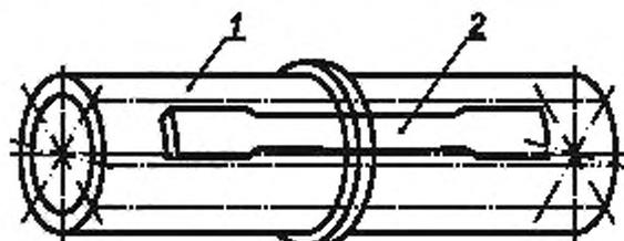
1 — патрубок со сварным соединением; 2 — расположение образцов
