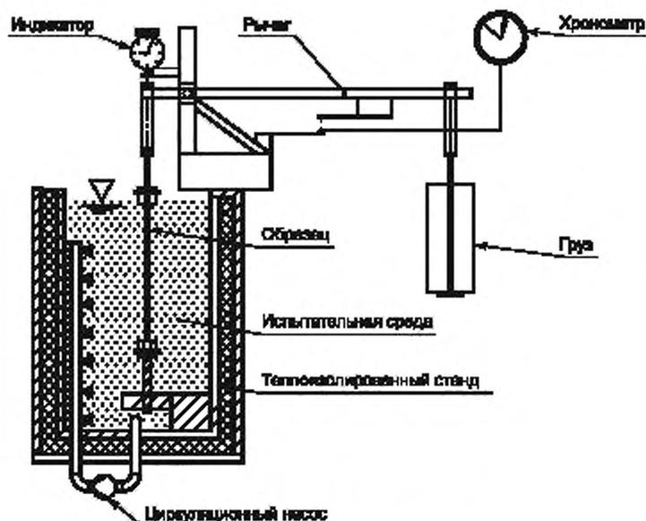
Рисунок 5 — Стенд для испытаний на ползучесть при растяжении
