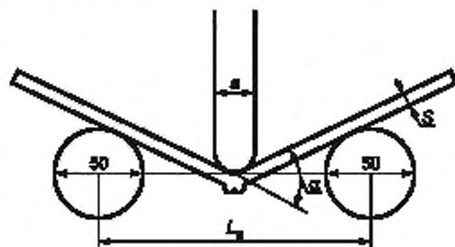
$S$  — толщина образца;  $\alpha$  — угол изгиба;  $a$  — толщина пуансона, конец имеет форму полукруга;
