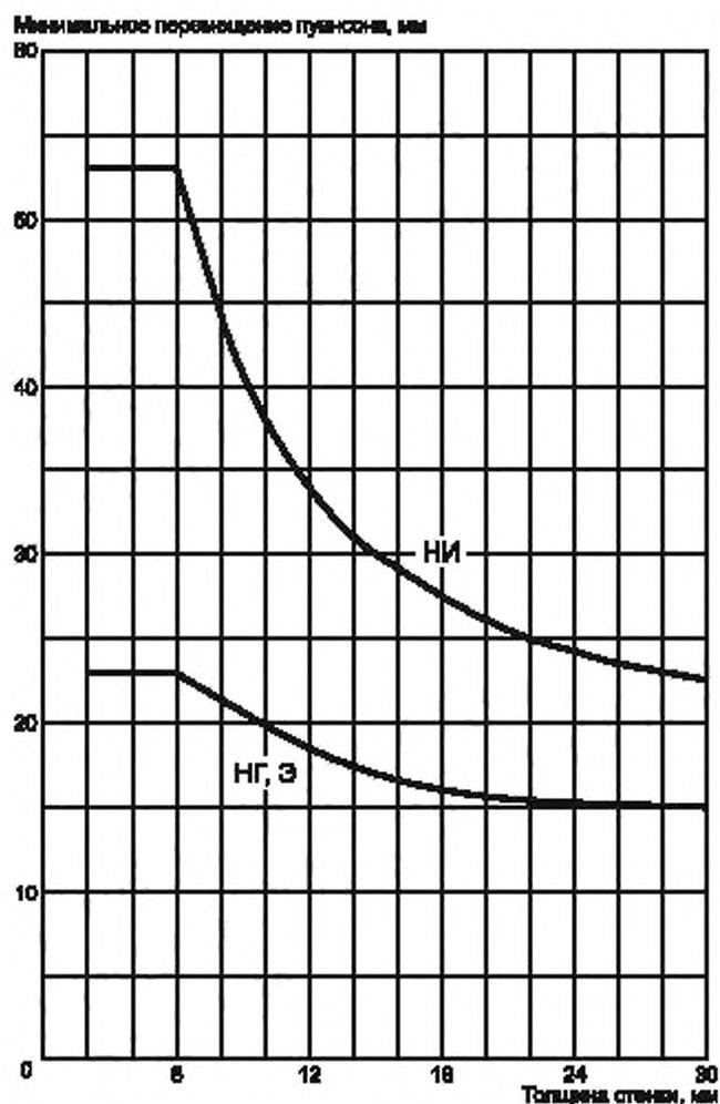
Рисунок В.9 — Минимальное перемещение пуансона для ПП-Р (тип 3) в зависимости от толщины для разных методов сварки (верхняя кривая — для сварки нагретым инструментом встык, нижняя — для прутковой сварки нагретым газом и экструзионной сварки)
