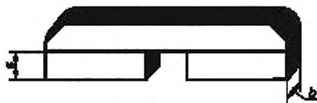
Образец, выполненный нагретым инструментом в раструб
