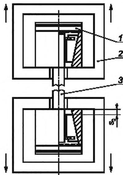
1 — зажим, 2 — приспособление для испытания, 3 — образец
