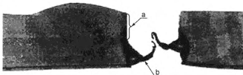
а -- зона поверхности разрушения, которая претерпела хрупкое разрушение (не менее 30 %).
