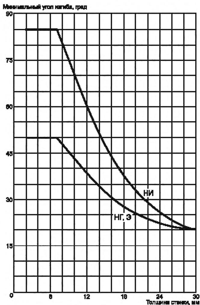
**Рисунок В.2** — Минимальный угол катба для ПП-В, ПП-Г и электропроводящего ПЭ в зависимости от толщины для разных методов сварки (верхняя кривая — для сварки нагретым инструментом встык, нижняя — для прутковой газовой сварки и экструзионной сварки)
