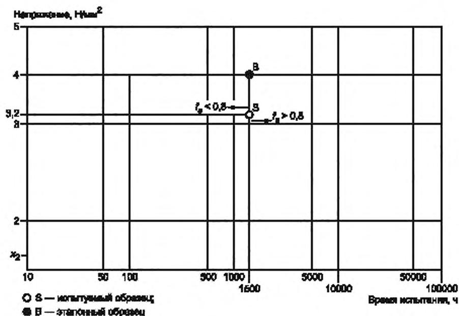
Рисунок 9 — Упрощенный метод подтверждения требуемого коэффициента сварного шва при испытании на ползучесть при растяжении
