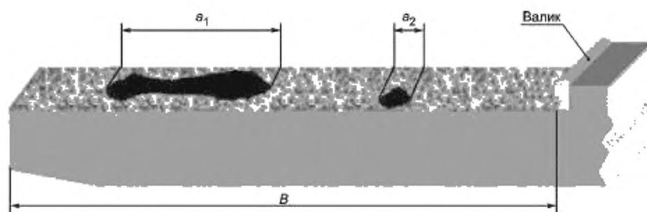
Рисунок А.2 — Оценочная длина  $V$  и примеры дефектов ( $a_1$  и  $a_2$ ) в случае образцов, которые выполнены сваркой нагретым инструментом (НИ) в раструб
