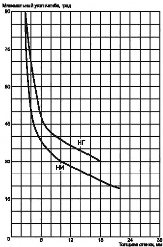
Рисунок В.4 — Минимальный угол изгиба для ПВХ в зависимости от толщины для разных методов сварки (нижняя кривая — для сварки нагретым инструментом встык, верхняя — для прутковой сварки нагретым газом)
