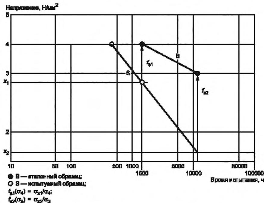
Рисунок 7 — Схема определения коэффициента прочности сварного шва  $f_z$  при длительных испытаниях на ползучесть при растяжении
