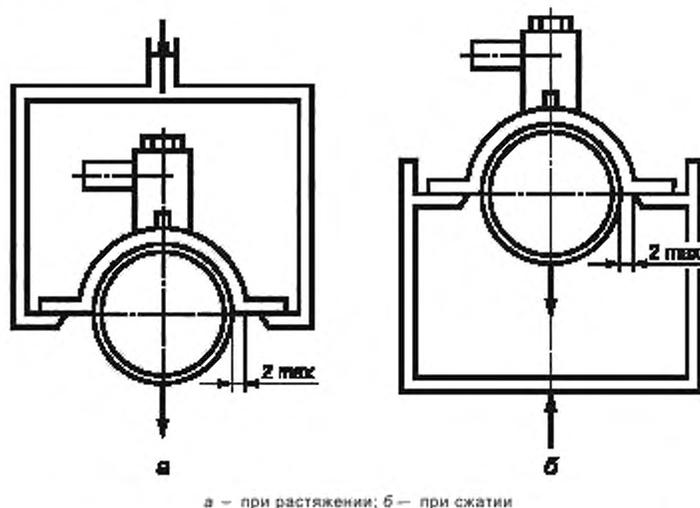
Рисунок 13 — Схемы испытания седловых полиэтиленовых отводов на отрыв
