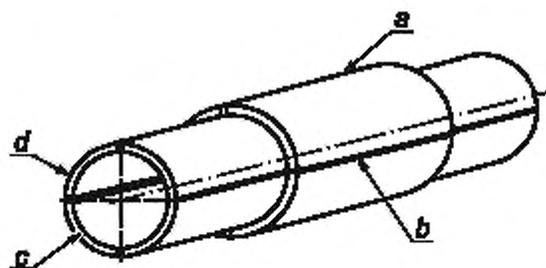
Рисунок Б.2 — Положения (от а до d) отбора образцов из соединений, выполненных раструбной сваркой с закладными нагревателями (неприменимо для седелок)
