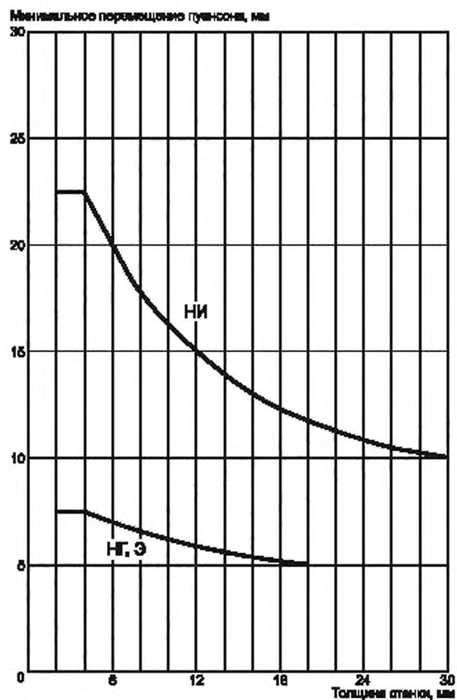
Рисунок В.11 — Минимальное перемещение пуансона для ПВХ в зависимости от толщины для разных методов сварки (верхняя кривая — для сварки нагретым инструментом встык, нижняя — для прутковой сварки нагретым газом и экструзионной сварки)
