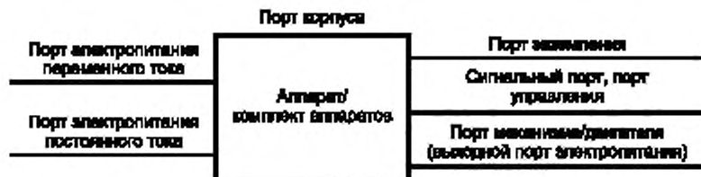
Рисунок 3 — Примеры портов аппарата/комплекта аппаратов
