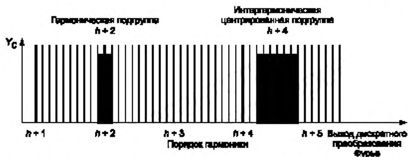
Рисунок 6 — Схема образования гармонических подгрупп и интергармонических центрированных подгрупп (для систем электроснабжения частотой 50 Гц)
