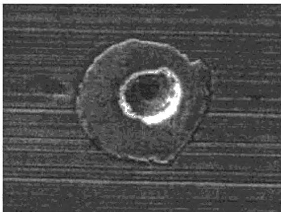
Рисунок 17 — Точечная коррозия подшипников из-за электрического разряда (диаметр коррозионной язвы — от 30 до 50 мкм)
