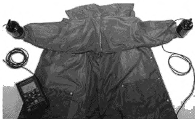
Рисунок 4 — Испытательная сборка — сопротивление «от точки до точки» (процедура «манжета-манжета» с использованием изолирующих вкладок)
