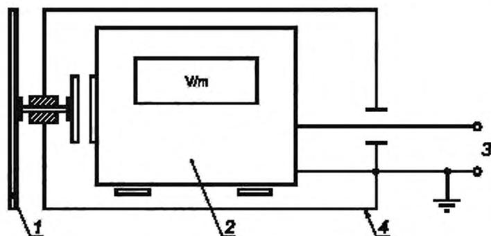
1 — изолированный электрод; 2 — измеритель поля; 3 — внешний вывод; 4 — экран
