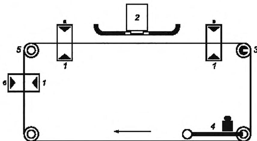
а — оценка эффективности нейтрализации; б — наблюдение заряда свободного ролика; в — вторичный прикладываемый заряд; г — нейтрализатор; д — измеритель поля; е — ролик с приводом; ж — подвижная ось с нагрузкой на ленту; з — свободно вращающиеся ролики
