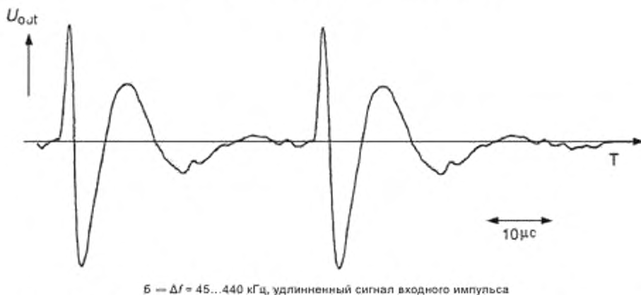
Рисунок Д.1. лист 1 — Сигналы выходного напряжения U_{out} двух разных измерителей ЧР для кажущегося заряда (двойной импульс)
