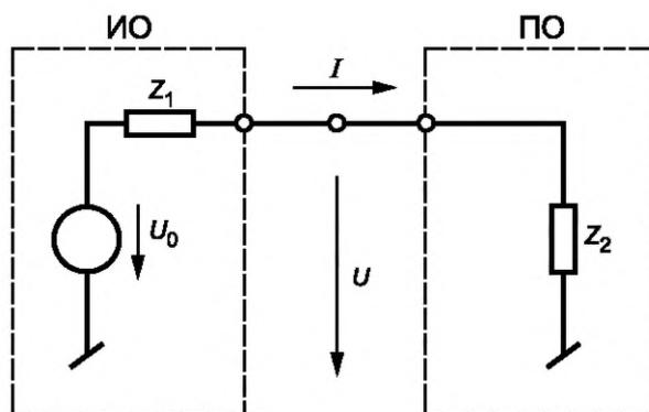
ИО — испытываемое оборудование; ПО — подключаемое оборудование;  $Z_1$  — общее несимметричное полное сопротивление ИО;  $U_0$  — напряжение источника ИРП;  $U$  — общее несимметричное напряжение ИРП на порте связи;  $I$  — общий несимметричный ток ИРП на порте связи;  $Z_2$  — общее несимметричное полное сопротивление ПО
