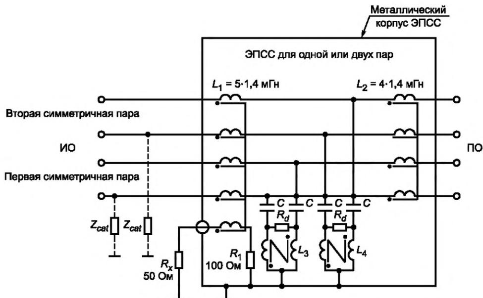
$C = 82$  нФ;  $L_3 = 2 \cdot 3,1$  мГн;  $L_4 = 2 \cdot 3,1$  мГн;  $R_d = 390$  Ом;  $R_x$  — вход измерителя ИРП; ПО — подключаемое оборудование; ИО — испытываемое оборудование;  $L_3$  и  $L_4$  обеспечивают индуктивность дифференциального режима  $4 \cdot 3,1 = 12,4$  мГн
