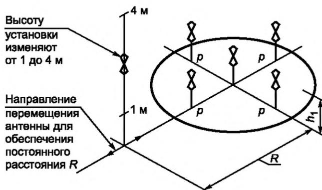
$p$  — точки размещения измерительных антенн, находящихся на окружности, описываемой крайней точкой ИО при вращении на  $360^\circ$ ;  $h_1$  — высота передающей антенны ( $h_1 = 1$  и  $1,5$  м);  $R$  — расстояние между вертикальными проекциями центров передающей и приемной антенн
