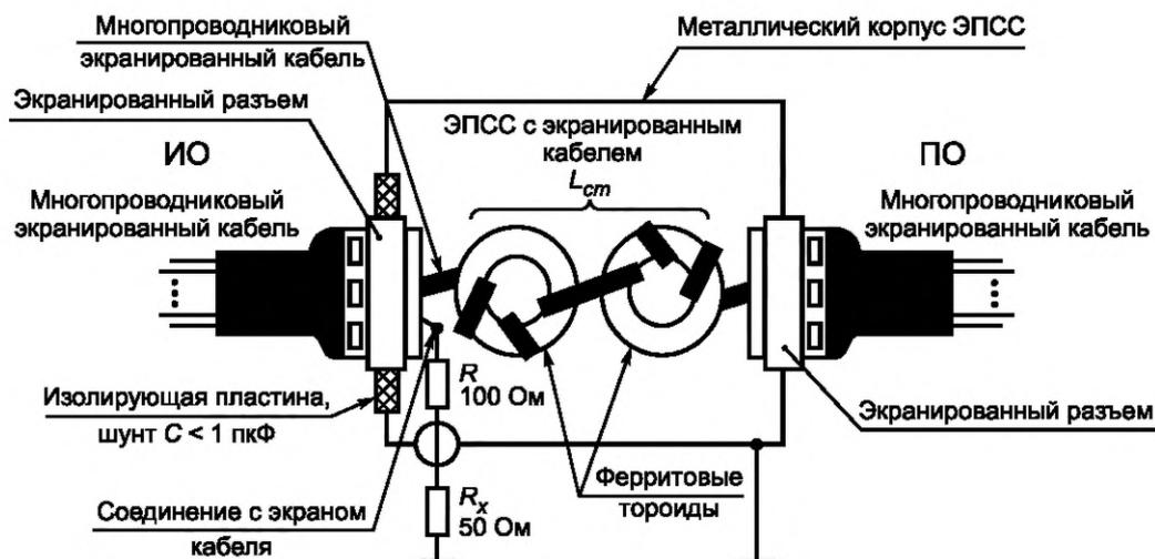
ПО — подключаемое оборудование; ИО — испытуемое оборудование;  $R_x$  — вход измерителя ИРП; дроссель общего несимметричного режима  $L_{cm} > 9$  мГн, общий паразитный шунт  $C < 1$  пкФ
