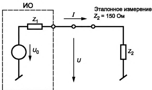
ИО — испытуемое оборудование;  $Z_1$  — общее несимметричное полное сопротивление ИО;  $U_0$  — напряжение источника ИРП;  $U$  — общее несимметричное напряжение ИРП на порте связи;  $I$  — общий несимметричный ток ИРП на порте связи;  $Z_2$  — общее несимметричное полное сопротивление нагрузки
