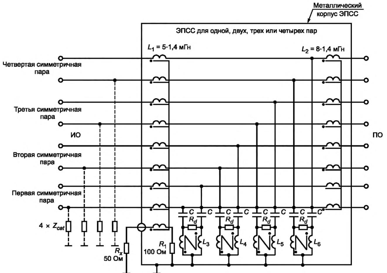
$C = 82$  нФ;  $L_3, L_4, L_5, L_6 = 2 \cdot 3,1$  мГн;  $R_x$  — вход измерителя ИРП;  $R_d = 390$  Ом; ПО — подключаемое оборудование; ИО — испытуемое оборудование
