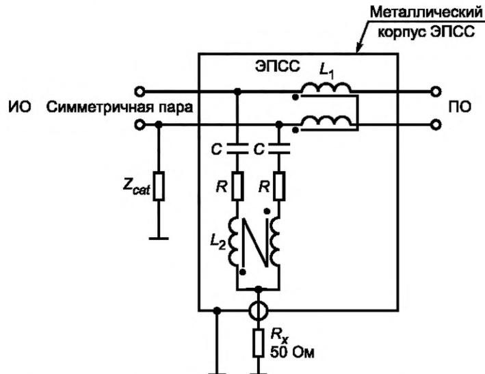
$C = 47$  мкФ;  $R = 200$  Ом;  $L_1 = 2 \cdot 38$  мГн;  $L_2 = 2 \cdot 38$  мГн;  $R_x$  — вход измерителя ИРП; ПО — подключаемое оборудование; ИО — испытываемое оборудование
