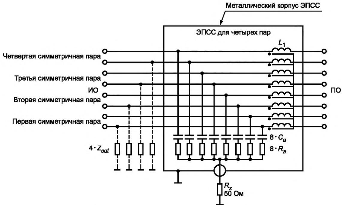
$C_a = 33$  нФ;  $R_a = 800$  Ом;  $L_1 = 8 \cdot 7$  мГн;  $R_x$  — вход измерителя ИРП; ПО — подключаемое оборудование;
