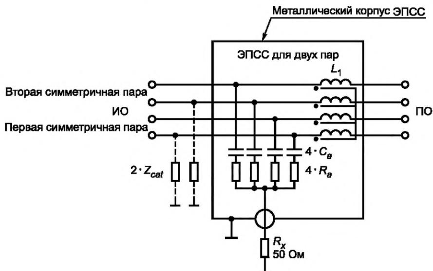
$C_a = 33$  нФ;  $R_a = 400$  Ом;  $L_1 = 4 \cdot 7$  мГн;  $R_x$  — вход измерителя ИРП; ПО — подключаемое оборудование;
