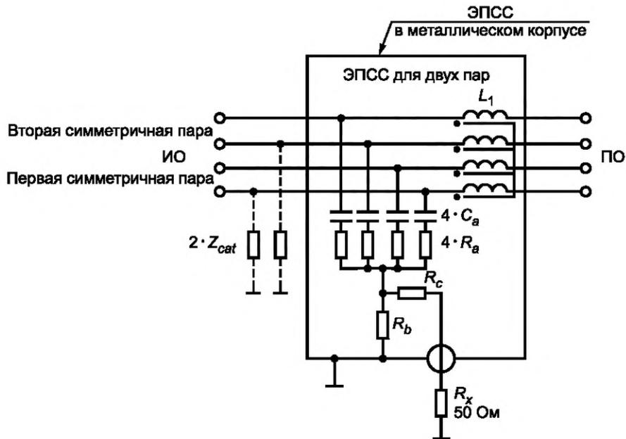
$C_a = 33$  нФ;  $R_a = 576$  Ом;  $R_b = 6$  Ом;  $R_c = 44$  Ом;  $L_1 = 4 \cdot 7$  мГн;  $R_x$  — вход измерителя ИРП;
