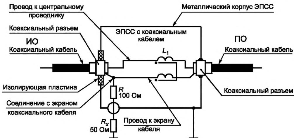
$R_x$  — вход измерителя ИРП; дроссель общего несимметричного режима  $L_1 = 2 \cdot 7$  мГн; ПО — подключаемое оборудование;
