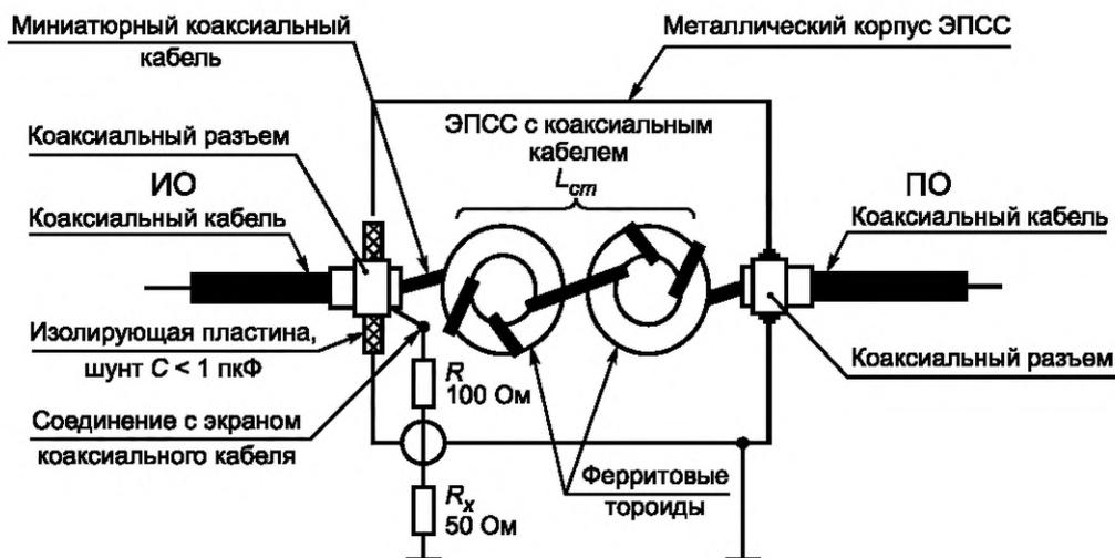
ПО — подключаемое оборудование; ИО — испытуемое оборудование;  $R_x$  — вход измерителя ИРП; дроссель общего несимметричного режима  $L_{ст} > 9$  мГн, паразитная емкость  $C < 1$  пкФ
