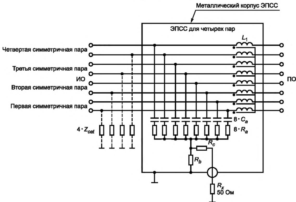
$C_a = 33$  нФ;  $R_a = 1152$  Ом;  $R_b = 6$  Ом;  $R_c = 44$  Ом;  $L_1 = 8 \cdot 7$  мГн;  $R_x$  — вход измерителя ИРП;
