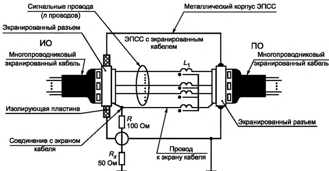
ПО — подключаемое оборудование; ИО — испытуемое оборудование;  $R_x$  — вход измерителя ИРП; дроссель общего несимметричного режима  $L_1 = (n + 1) \cdot 7$  мГн, где  $n$  — число сигнальных проводов
