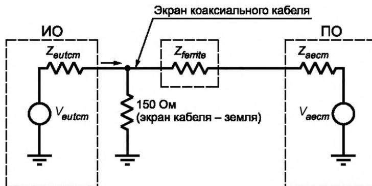
$V_{eutcm}$  — общее несимметричное напряжение ИРП, создаваемое ИО;  $Z_{eutcm}$  — общее несимметричное полное сопротивление ИО;
