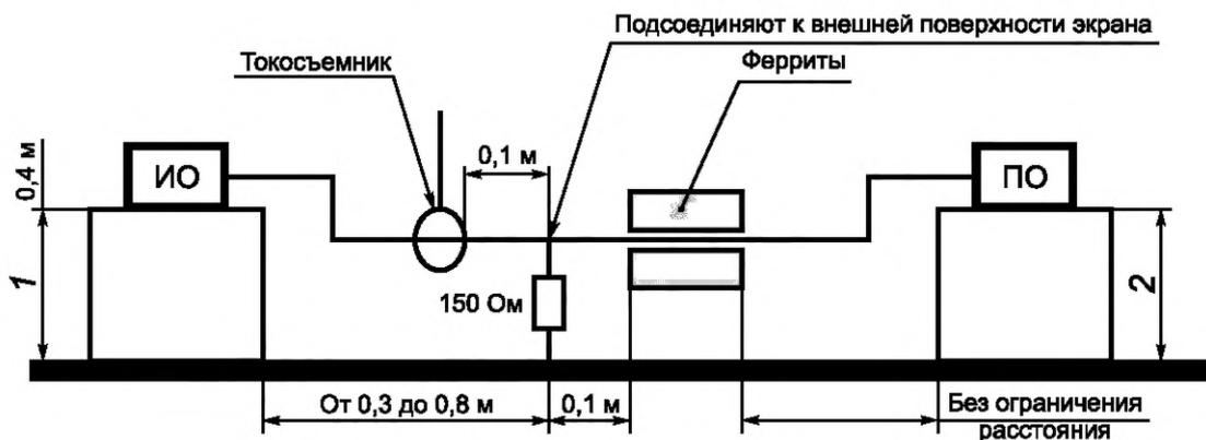
ИО — испытательное оборудование; ПО — подключаемое оборудование; 1 — расстояние до пластины заземления (вертикальной или горизонтальной); 2 — расстояние до пластины заземления, не являющееся критическим
