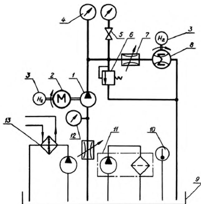
1 – испытуемый насос; 2 – балансирный динамометр; 3 – тахометр; 4 – манометр; 5 – кран; 6 – предохранительный клапан; 7 – дроссель; 8 – расходомер; 9 – бак; 10 – термометр; 11 – фильтровальная установка; 12 – вакуумметр; 13 – теплообменник.
