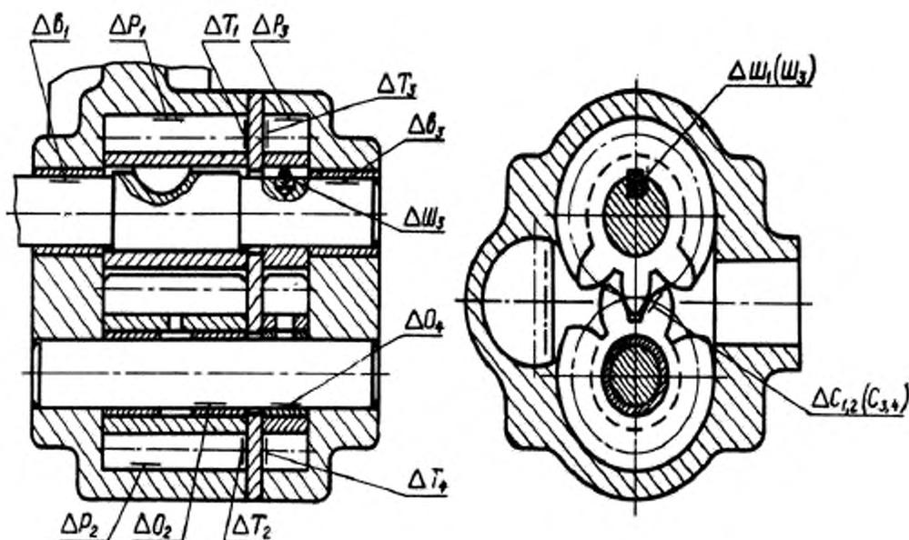
Зазоры:  $\Delta P$  – радиальный;  $\Delta T$  – торцевой;  $\Delta C$  – боковой в зацеплении зубьев качающего узла;  $\Delta B$  – подшипников (опор) ведущего (ведомого) валов;  $\Delta O$  – подшипников оси (ведомых шестерен);  $\Delta \Delta$  – шпоночного (неподвижного) соединения вал-шестерня
