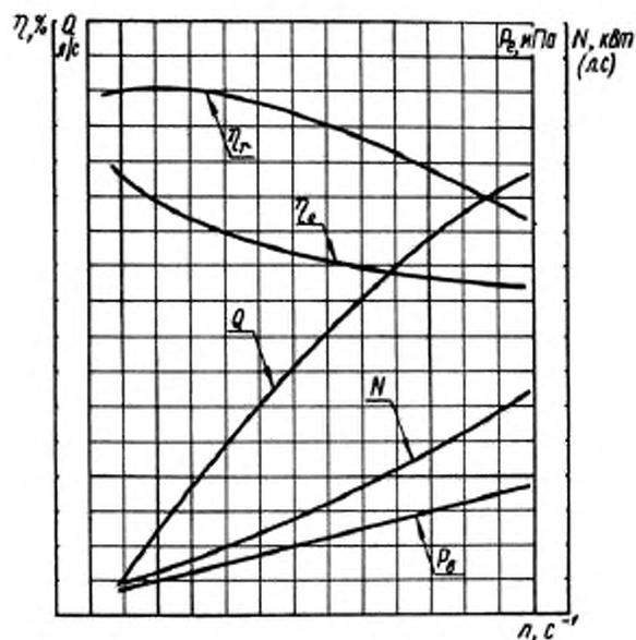
$\eta_c$  – общий (эффективный) КПД насоса;  $\eta_v$  – объемный КПД насоса;  $Q$  – действительная подача насоса;  $N$  – потребляемая мощность на привод вала насоса;  $P_a$  – разрежение во всасывающей полости насоса
