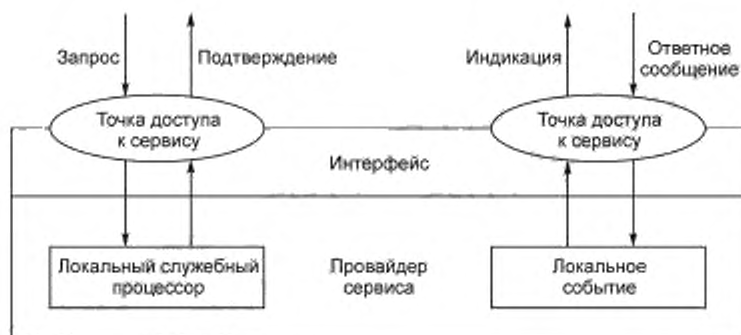
Рисунок 1 — Обработка локального RMS-события
