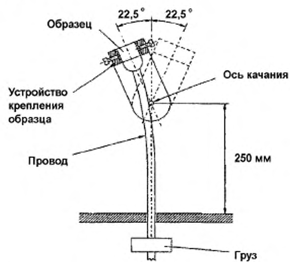
Рисунок 103 – Пример устройства для проведения испытаний на гибкость
