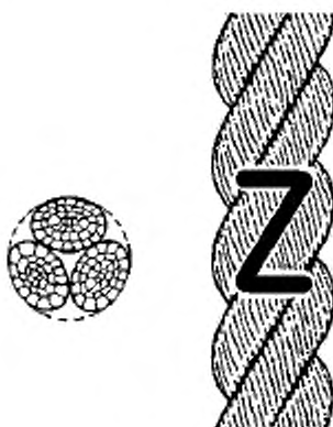
Рисунок 1 – Конфигурация 3-рядного (hawser-laid) каната (тип А)
