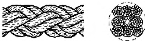
Рисунок 3 – Конфигурация 8-рядного плетеного каната (тип L)
