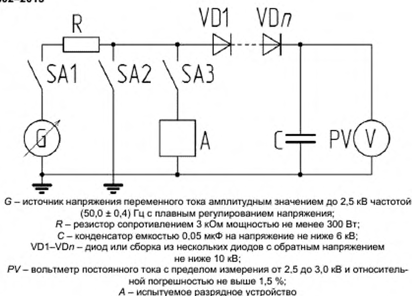
Рисунок 1 – Схема для проверки напряжения срабатывания разрядного устройства
